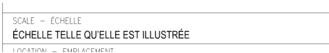
Figure 5-6 : Note de l'échelle dans le cartouche
